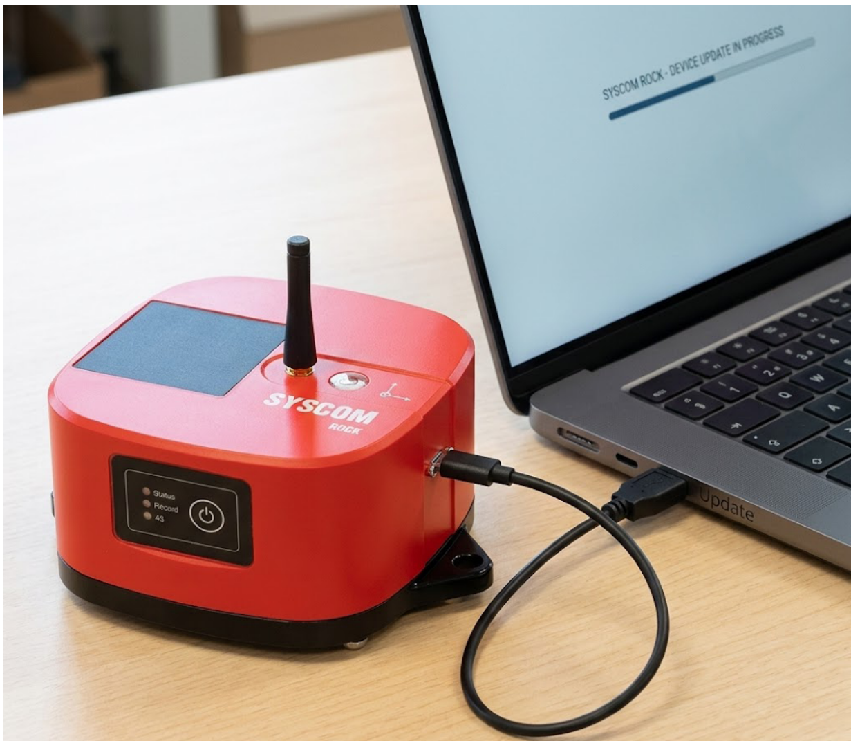
Abb. 2: Verbindung des ROCK über das USB-Kabel mit einem Laptop
